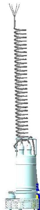
**Рисунок Д.2** - Общий вид спирального кабеля на электронасосе с автоматизацией.
