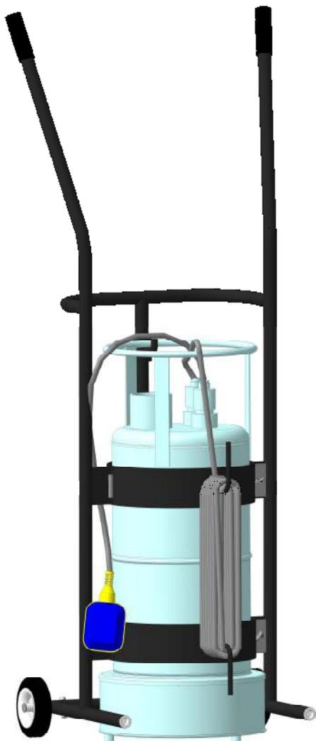
**Рисунок Г.1** – Тележка для транспортирования электронасоса типа ГНОМ 100-25
