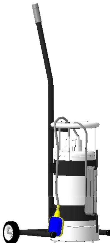
**Рисунок Г.2** – Тележка для транспортирования электронасоса типа ГНОМ 40-25, ГНОМ 53-10, ГНОМ 50-25
